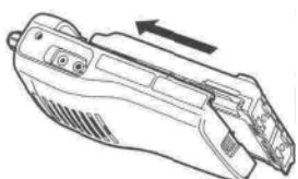
Двигайте аккумулятор по задней части трансивера до срабатывания защелки.
